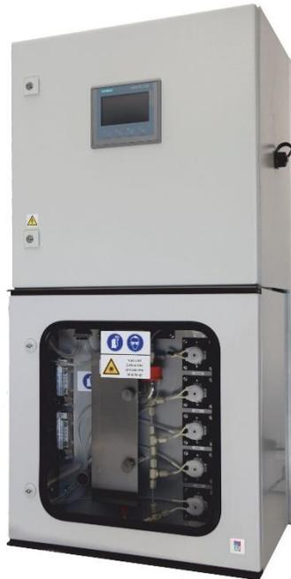
Die Elektronik und die nass-chemischen Komponenten des **PAITOC** sind in zwei getrennten Gehäusen untergebracht.
